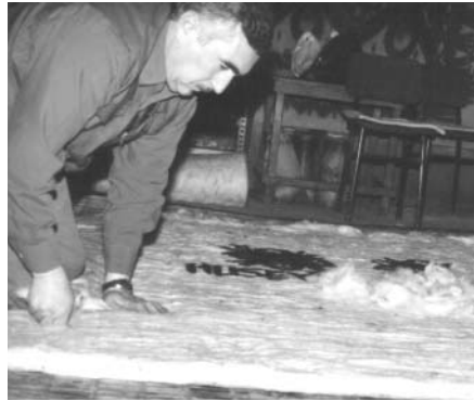
Şekil 11 - Hazırlanmış keçenin tepme makinesine yerleştirilmesi
