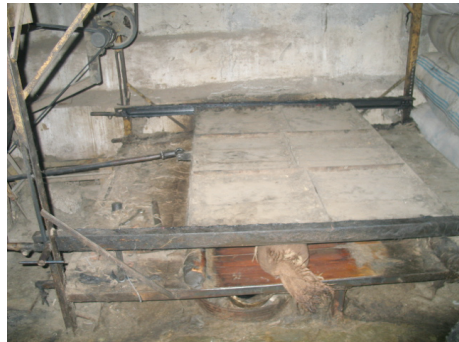
Resim 5: Keçe yapımında kullanılan yün tep- me makinesi.
